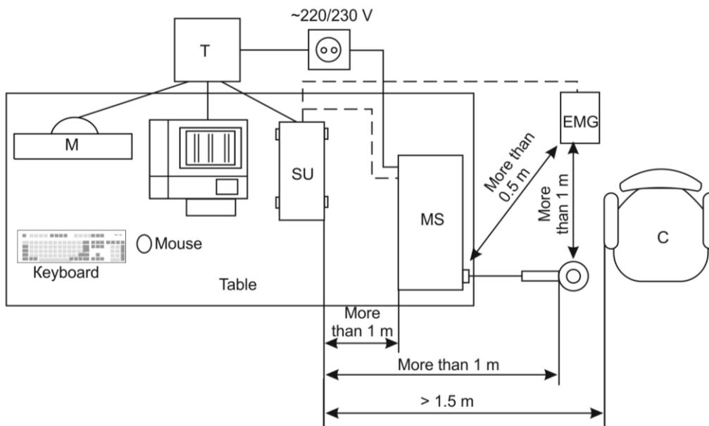
O desenho do esquema de colocação de estimulador durante a conexão com sistemas de EMG digitais fabricados pela **Neurosoft**.
