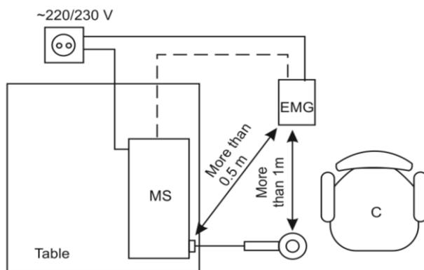
O desenho do esquema de colocação de estimulador durante a conexão com sistemas de EMG digitais produzidos por outros fabricantes.
